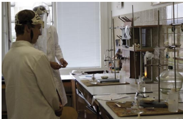
Obr.č.2: Příprava černého střelného prachu z dusičnanu draselného, síry a uhlí
